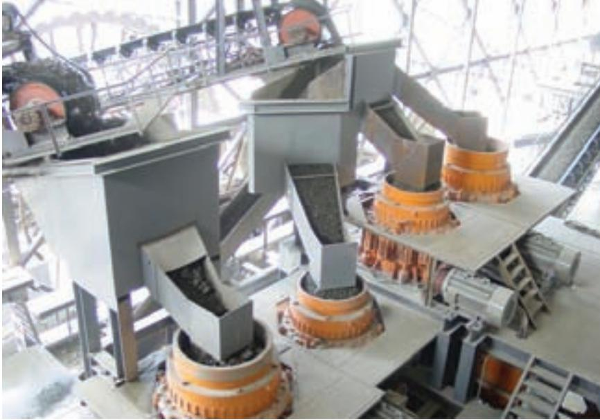
**ZYC** 系列复合圆锥破碎机，可广泛应用于金属与非金属矿、水泥厂、建筑、砂石冶金等行业。适用于铁矿石、有色金属矿石、花岗岩、石灰石、石英岩、沙岩、鹅卵石等。破碎腔型：C——粗碎腔型；M——中腔腔型；F——细碎腔型；EF——超细碎腔型。
